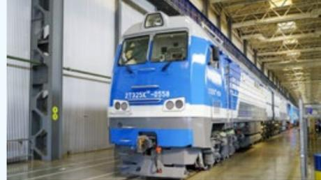
Один из поставленных локомотивов оборудован двухпроводной системой энергоснабжения пассажирских вагонов, что позволяет использовать его с вагонами современных серий, прежде всего – с двухэтажными. Другой построенный для Туркменистана магистральный грузовой двухсекционный тепловоз 2ТЭ25КМ обладает электрической передачей переменного тока и способен обеспечивать вожде-ние поездов массой до 6,4 тысячи тонн.
